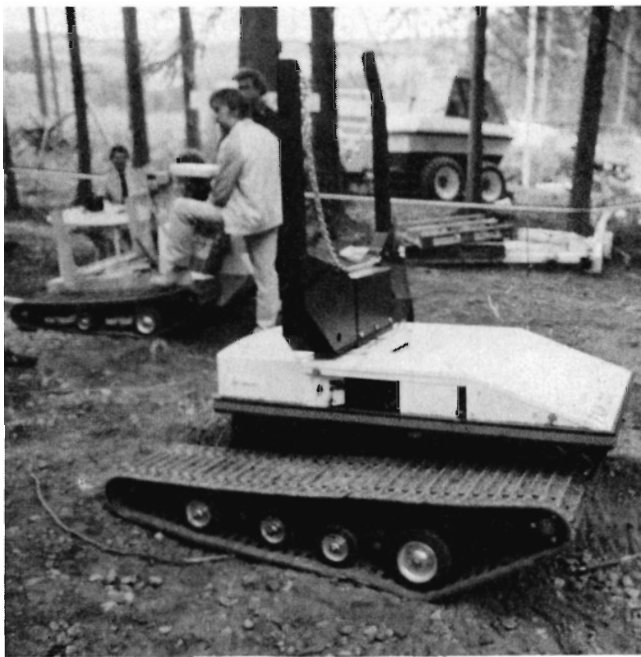
♦ Figur 7. Vestec har udviklet en hydrostatisk drevet jernhest, der kan radio-dirigeres. Her monteret med en klembanke.
