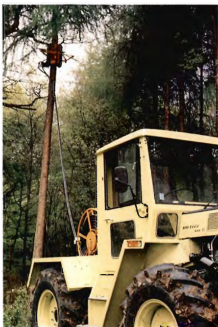
Figur 4. Baumhexe er en tysk stammeopkvister, der ved hjælp af et hydraulisk drivsystem kører op ad stammen.
