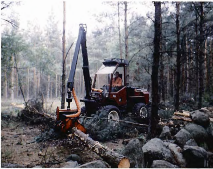
Figur 1. ØSA-Lillebror er en lille basismaskine til fældnings- og skovningsopgaver i tyndinger. Dens to pendelaksler er hydraulisk stabiliserede, således at krængninger mindskes.
