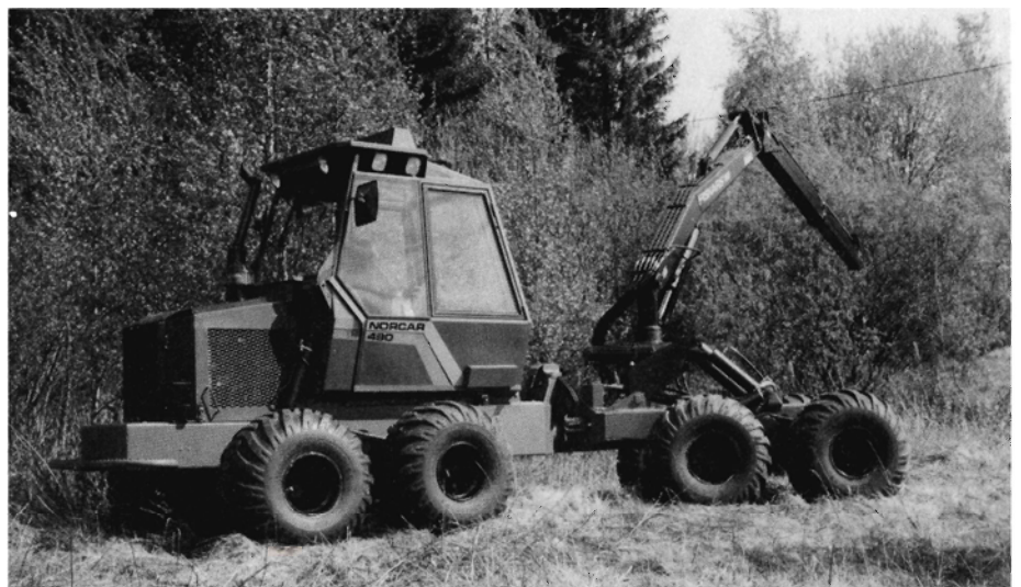
Figur 3. Norcar 490 TH er en prototype på en basismaskine for en et-grebs fælder-oparbejder. Man har drejet den forreste maskinhalvdel 180° i forhold til udkørselstrakto-ren.
