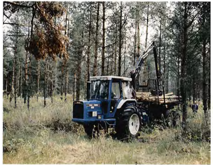
Figur 6. Bruun F 7610 er en middelstor udkørselstraktor, hovedsaglig baseret på Ford-komponenter.
