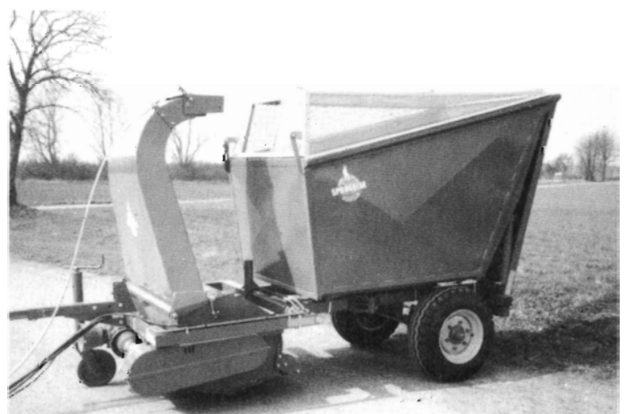
Figur 3. Slåning og samtidig opsamling af højt græs vises med Spragelse Maskinfabriks nye Park Combi-trailer .
