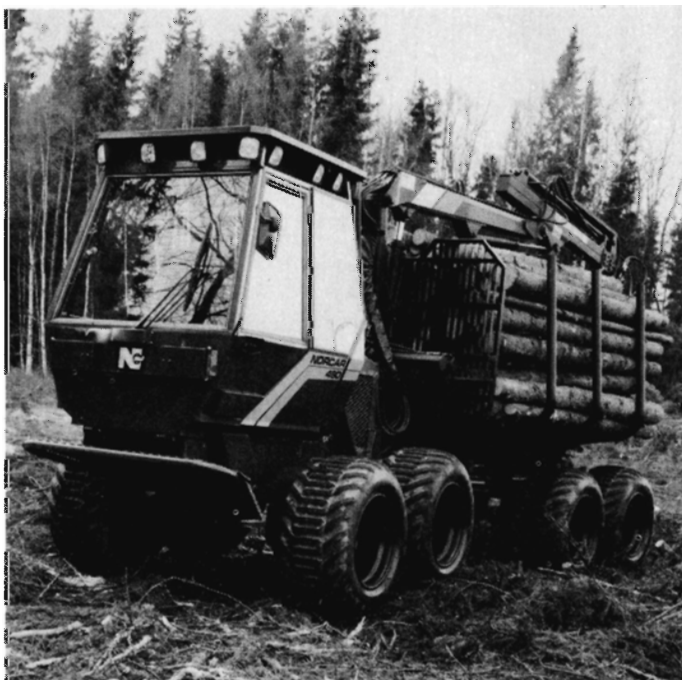
Figur 6. Norcar 490. Den her monterede kran har en rækkevidde på 7,5 m.
