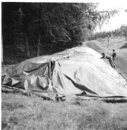
Fig. 1. Flis fremstillet af fortørrede træer bør opbevares overdækket. Her er vist et eksempel fra Nødebo distrikt.
