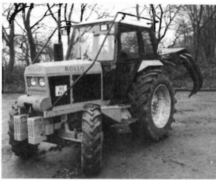
Fig. 6. Rollo skovtraktor med mekanisk firehjulsdriv.
