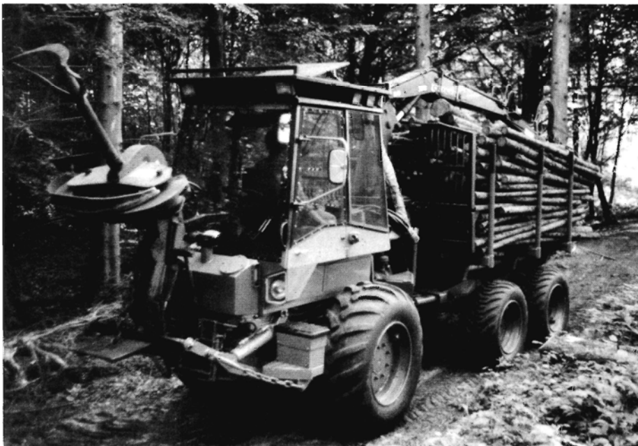
Fig. 5. Gremo 603 er en ny lille udkørselstraktor. Maskinen er her monteret med lift og kraftudtag i fronten, således at den kan bruges til andre opgaver, f. eks. udslæbning m. tang.
