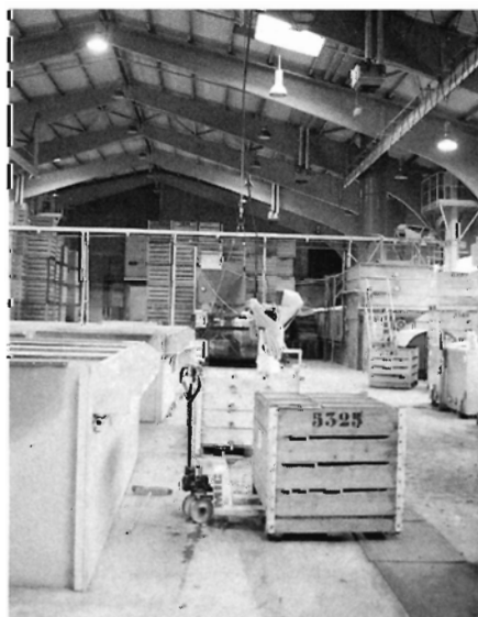
Foto 1. På "La Joux" er der i 1982 indrettet en stor separat frøbehandlingshal alene til olden. Her sker rensning og tørring af bog samt varmebehandling af agern.
