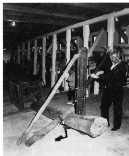
Figur 6. Skovfoged Thyge Andersen demonstrerer en skovvippe til afkortning af liggende stammer.
