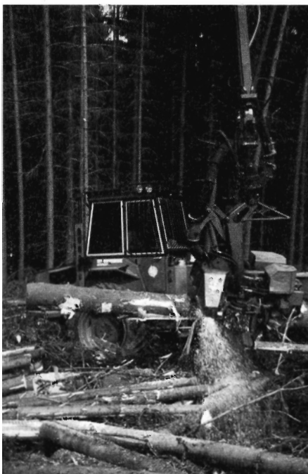
Figur 1. De danske skovningsmaskiner arbejder udelukkende med korttræseffekter på op til fem meter.
