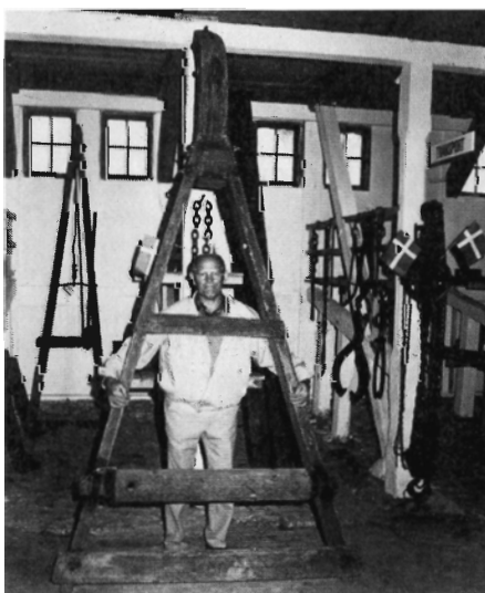
Figur 5. Skovfoged Fritz Larsen viser hvordan en skovkran kunne bæres af en mand fra sted til sted.
