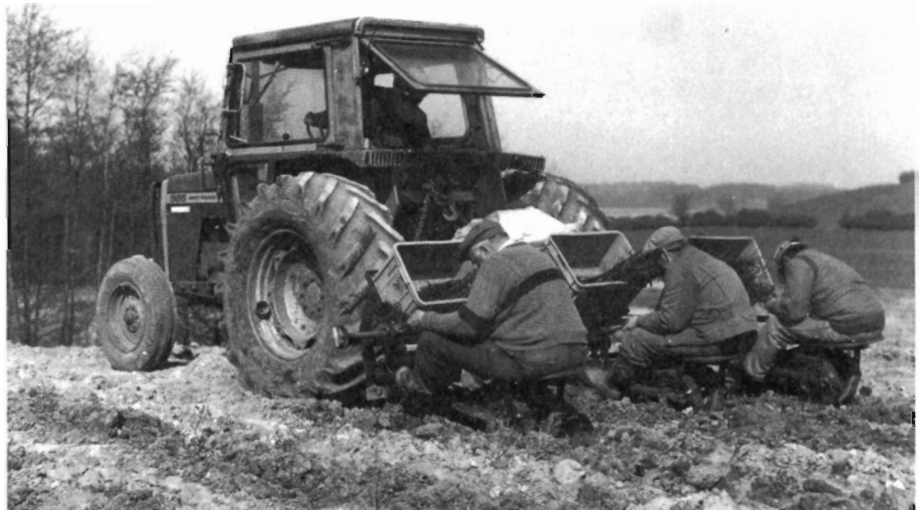
Figur 3. Plantningen sker ved en traktortrukket plantemaskine. En lille plov åbner en fure, planterne sættes ned med faste mellemrum, og jorden trykkes til igen.
