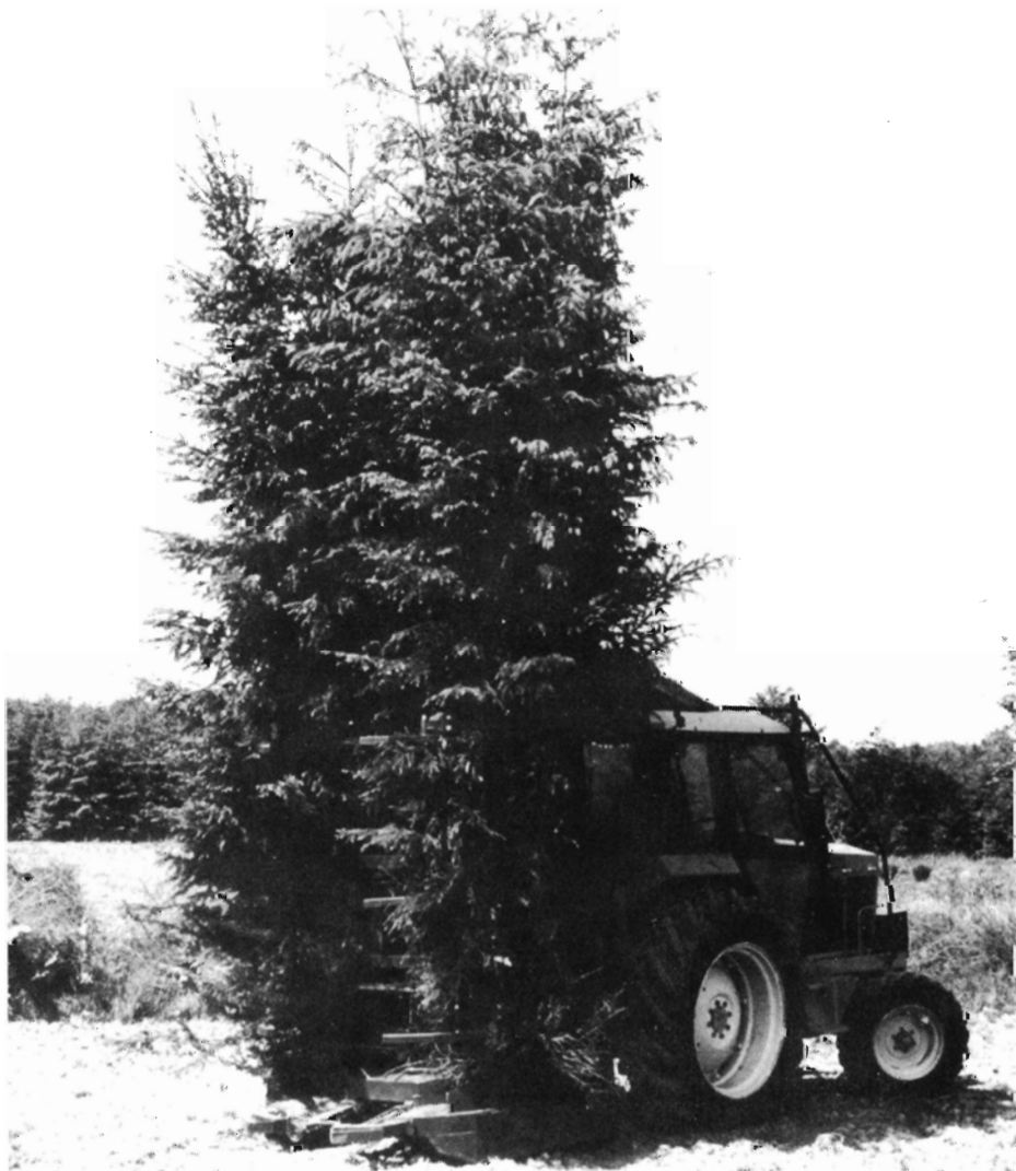
Fig. 3. Maskine til kontinuerlig fældning og bundtning af træer ved 1. tynding i nåletræ.
