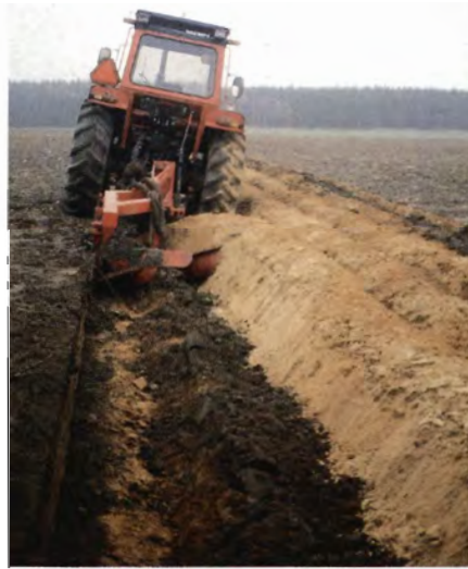
Foto 1: Reolpløjning er et drastisk, men effektivt middel til at undgå ukrudt. Det lille plovskær vender pløjelaget ned i den dybe fure, mens det store plovskær lægger mineraljord hen over pløjelaget (fra den forrige fure). Herved bliver pløjelaget med alle sine ukrudtsfrø dækket med mindst 20 cm mineraljord. (Foto 1-5: J. Neckelmann).
