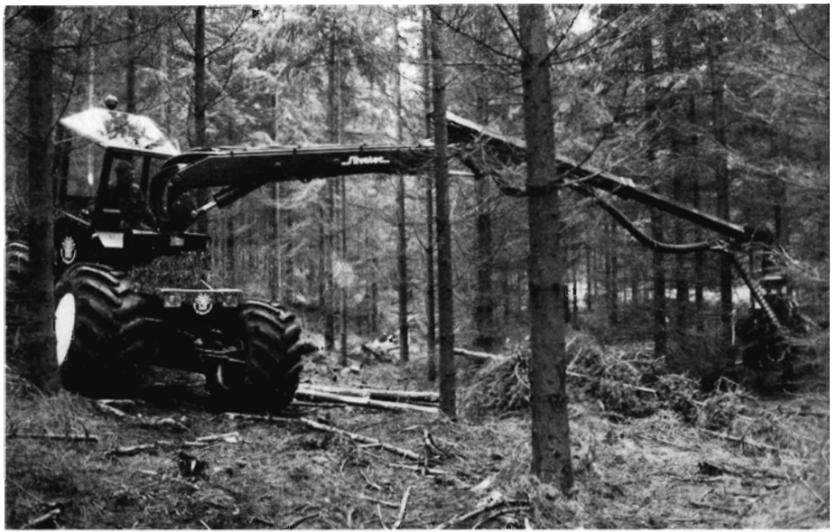
Figur 2. Med sin 9 m lange kran er Silvatec 454 den mest alsidige maskine.
