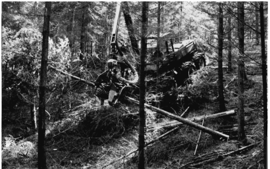
Figur 3. Den store Silvatec 854 er en stiksporsgående maskine som fordeler vægten godt med sine ialt 8 hjul.
