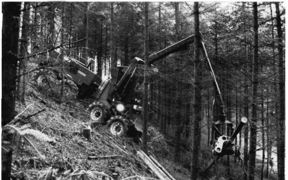
Figur 4. En ældre skovningsmaskine arbejder ubesværet på stejlt terræn, idet den bevæger sig lige nedad.
