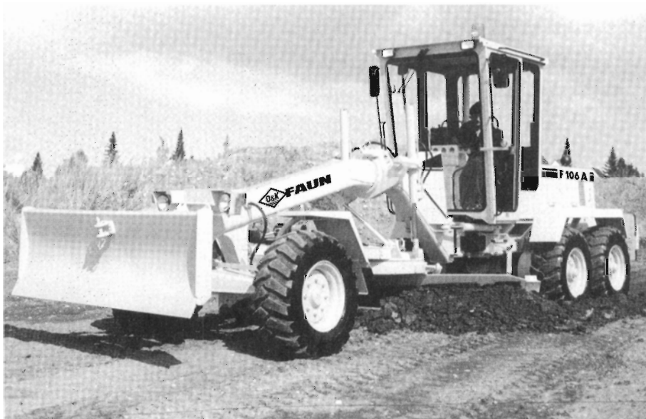
Figur 1. Anvendelse af grader sikrer optimalt genbrug af vejmaterialer – og dermed lave vejvedligeholdelsesomkostninger.
