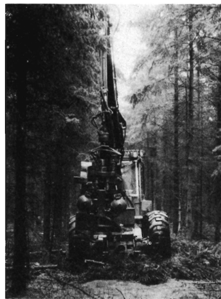
Figur 4. Gremo TT8/SK35 skovningsmaskine til tynding, som blev anvendt til undersøgelsen.
