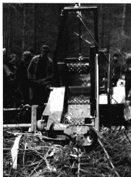
Fig. 1. Vimek tyndingsprocessor set i indmadningsretningen. Såvel maderuller som spil drives mekanisk, hvorimod svingning af processoren samt betjening af kvisteknive sker hydraulisk.
