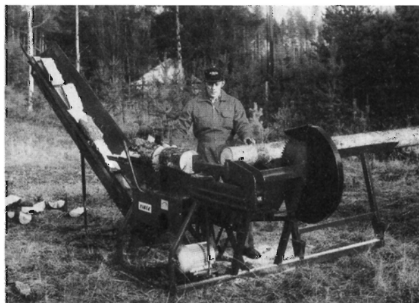
VIMEK, en kombimaskine med el-motor og til traktors kraftudtag i samme maskine. Ingen hydraulik. Hurtig og kraftig maskine. Med transportør.
