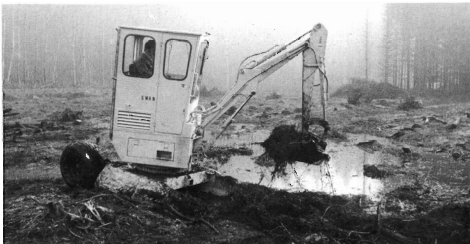
Fig. 1. Swan I er et eksempel på en lille let gravemaskine, der kan køre på grøftens sider. Maskinen er en videreudvikling af den engelske Smalley gravemaskine, men maskinen er dansk og laves på Henning Hansens Maskinfabrik i Rønede. Udviklingsarbejdet er sket sammen med Brdr. Svanebjerg, der også står for salget af maskinen. Pris okt. 82 250.000 kr. En billigere model til ca. 175.000 kr. er under udvikling.
