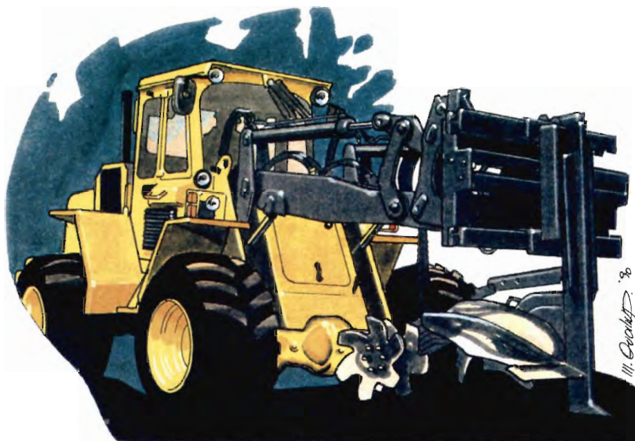
Figur 1. En gummiged forsynet med først en kvasgrab og derpå en særlig kulturplov (billedet) kan udføre rydning og klargøring af kulturarealer.
