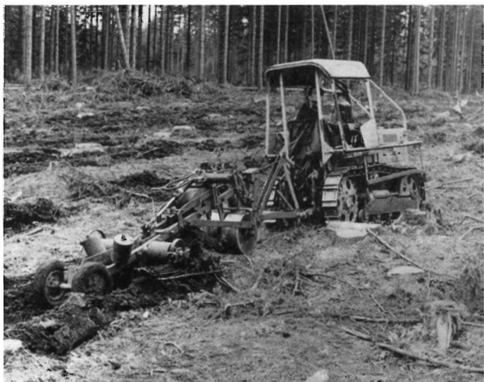
Figur 1. Bristol Traktor med Tolneplov. Brugt ved fornyelser i hedeplantagerne, hvor man ønskede en skærm over den ny kultur. Hver anden række bjergfyr blev hugget, og traktoren kunne pløje i de afskovede rækker.
