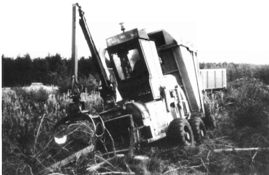
Figur 5. Udviklingen har i de senere år gået fra traktorer med flishuggere til egentlige specialbyggede – og væsentligt dyrere – flishugningsmaskiner. I de kommende år arbejdes der med at udvikle systemer til mekanisk afmåling, „integreret skovning” og specialbyggede udkørselsmaskiner. (Figuren viser den nyeste model fra Silvatec med indmadning i fronten).
