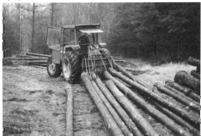
Figur 2. Ved sortering ved vejen er aflægningen mere besværlig og tidskrævende.
