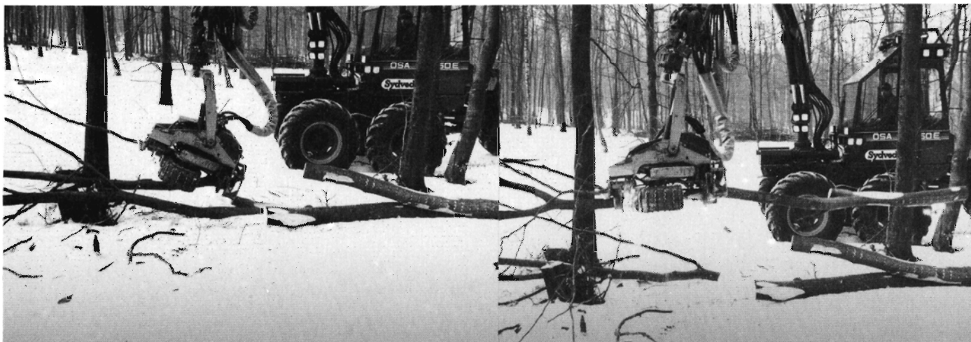
Figur 1. Sydved eksperimenterer med anvendelsen af kranmonterede skovningsaggregater i løvtræ. De større grene må afskæres manuelt eller med skovningsaggregatets sav.
