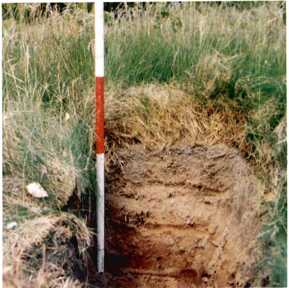
Fig. 2. 10 cm rodfilt isolerer jordvarmen under Bølget Bunke.
