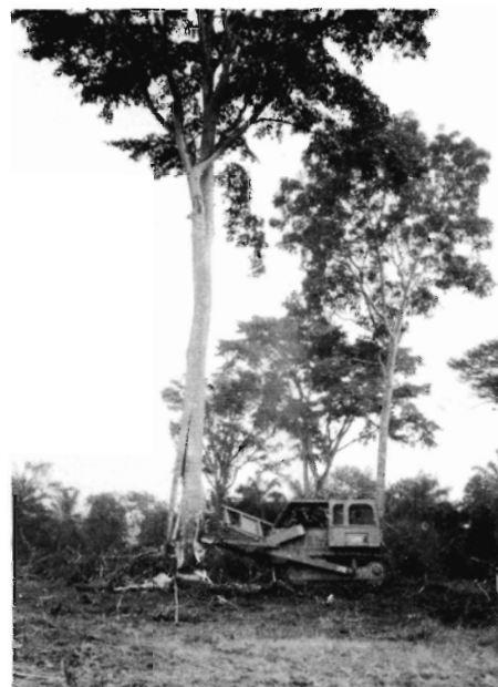
Fig. 1. Caterpillar D8 med KG-blad i færd med at flække en Chlorophora excelsa , fotograferet af J. Fries på International Institute of Tropical Forestry's demonstration af mekaniseret skovrydning. Nigeria, november 1982.
