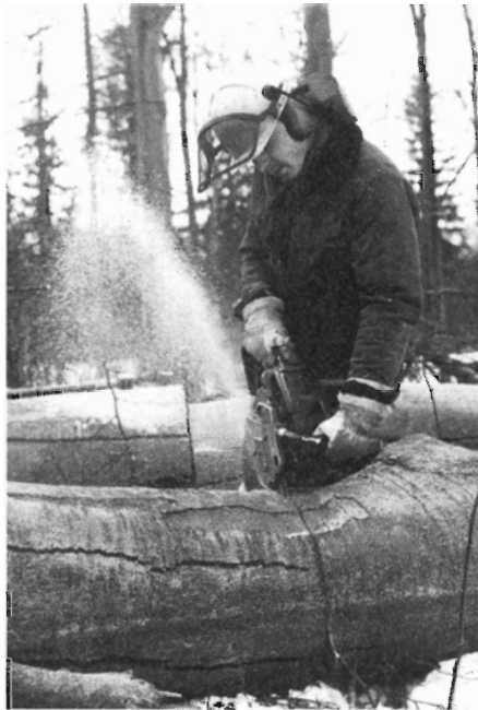
Figur 1. Undersøgelsen omtaler umiddelbare indtryk fra 15 skovarbejdere som har brugt den miljøvenlige benzin i 13 dage. Benzinen har et lavere indhold af bly, aromater, benzen og olefiner, og den er mindre flygtig end normal benzin.
