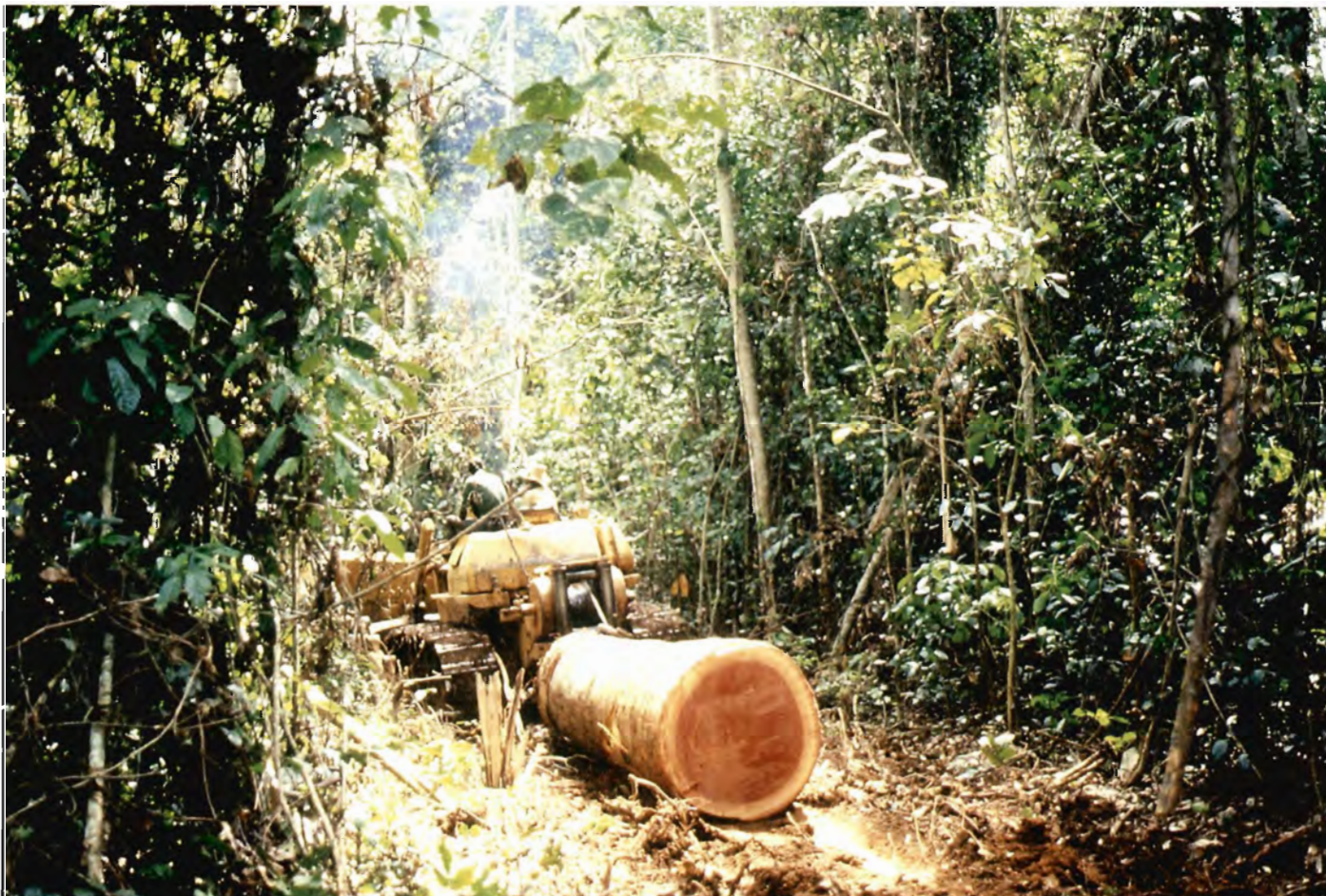
Figur 3. Bulldozeren maser vegetationen ned og trykker jorden sammen.
