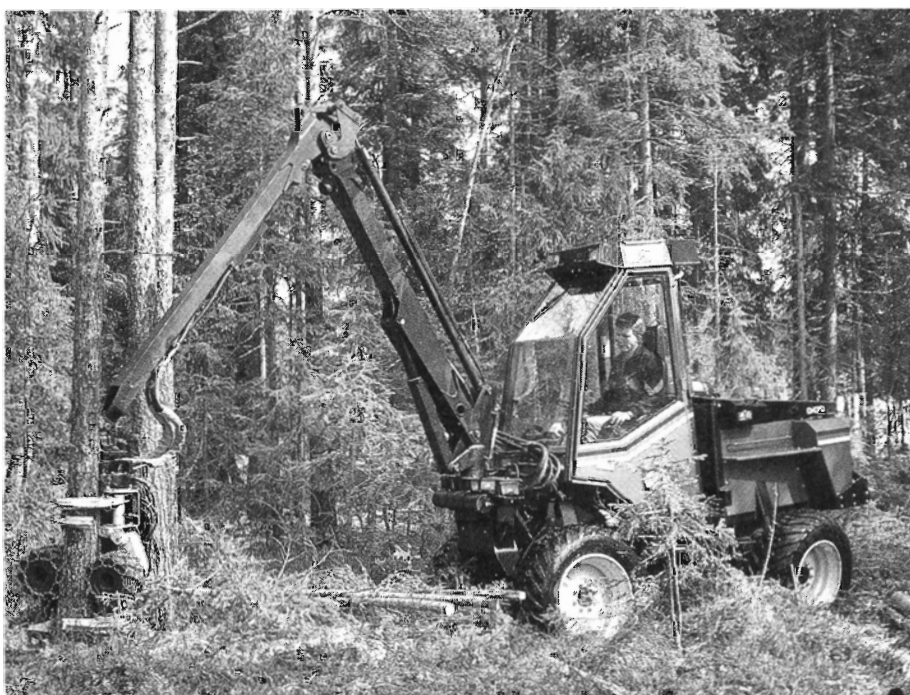
Figur 1. Mekaniseret skovning betyder i Sydsverige en besparelse på 35 skr./m 3 f i forhold til motormanuel skovning. (Foto viser ÖSA 0470).
