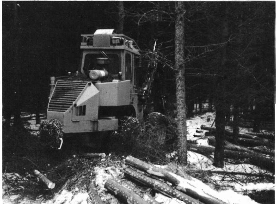
Figur 1. Microfant - første bestandsgående skovningsmaskine i Danmark, udviklet af Micro Nord og Skovteknisk Institut.
