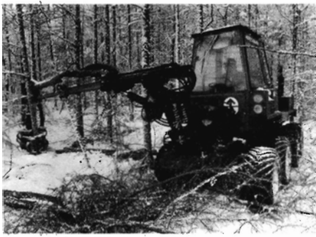
Figur 2. Kockum 8111 - ombygget til skovningsmaskine af Silvatec. Maskinens bredde er 1,8 m og vægten 5,5 t.
