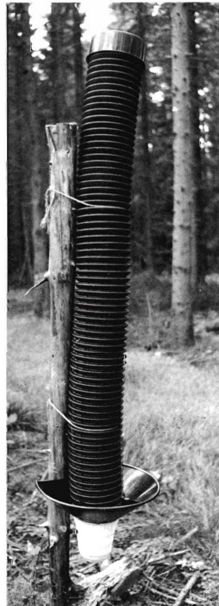
Fig. 3. Rørfælde til fangst af typografer. Inde i røret er ophængt en feromondispenser, der frigiver syntetisk fremstillet feromon (duftlokkemiddel). Biller, der lokkes til, kravler ind gennem huller i røret og opsamles i beholderen forneden. Såvel fælder som feromon forhandles herhjemme af Hedeselskabets Handelskontor, tlf. 06 - 62 61 11. Foto: Hans Peter Ravn.
