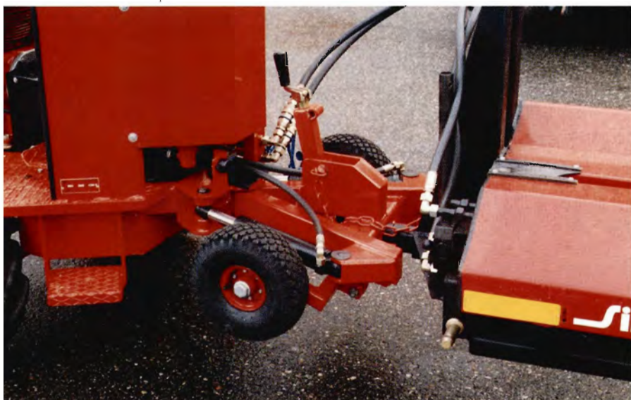
Fig. 2. Koblingen mellem basismaskinen (tv.) og netmaskinen (th.). Koblingen er forsynet med knækstyring i form af to cylindre (den ene er halvt skjult af hjulet i midten).
