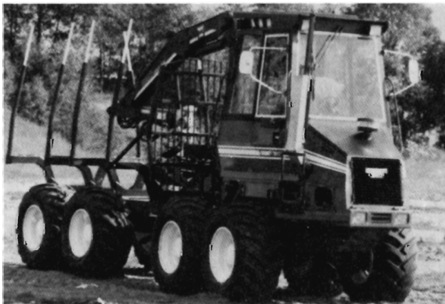
GREMO 704 T – Udkørselsmaskine.
