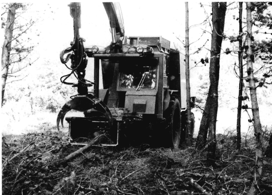
Figur 2. Flishugning er i praksis den eneste måde, hvorpå store plantagearealer kan ryddes og gentilplantes. Bemærk, at træerne tørrer et sommerhalvår, hvorved de fleste af de næringsrige nåle efterlades på skovbunden.
