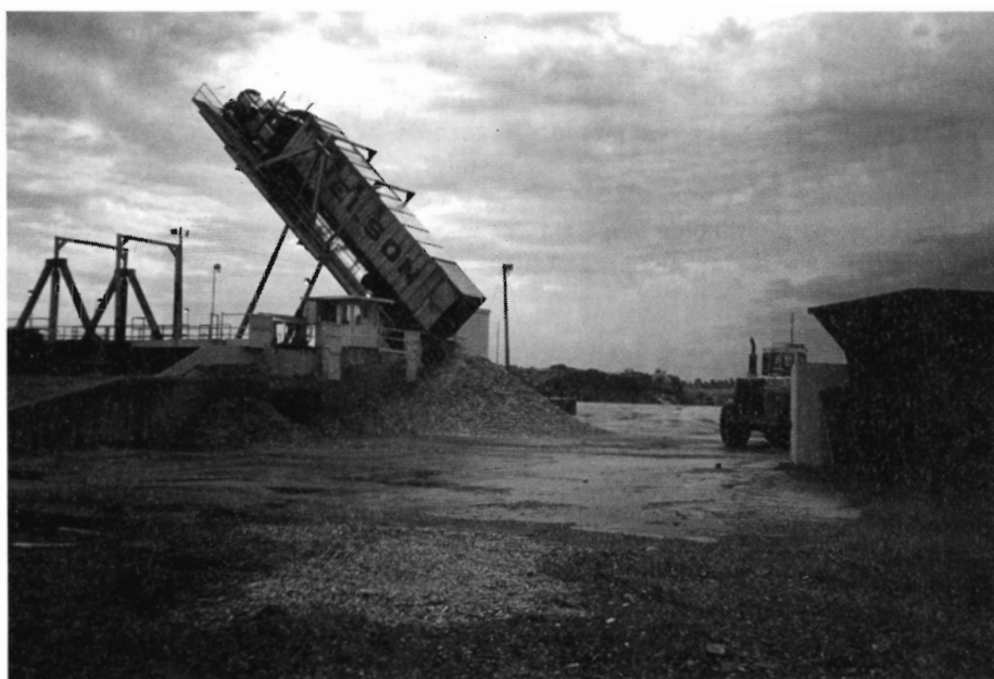
Hos Mead Paper gøres alt på den hurtige måde – tømning af flis fra lastvognstog.
