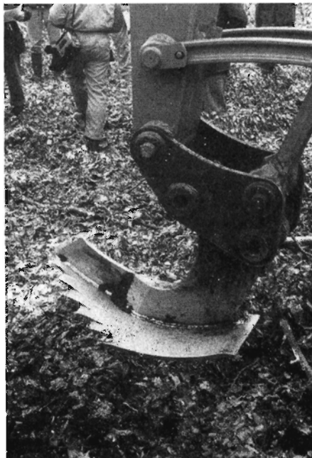
Figur 1. De syv tænder samt kløvekniven er slebet helt skarpe før demonstrationen starter.
