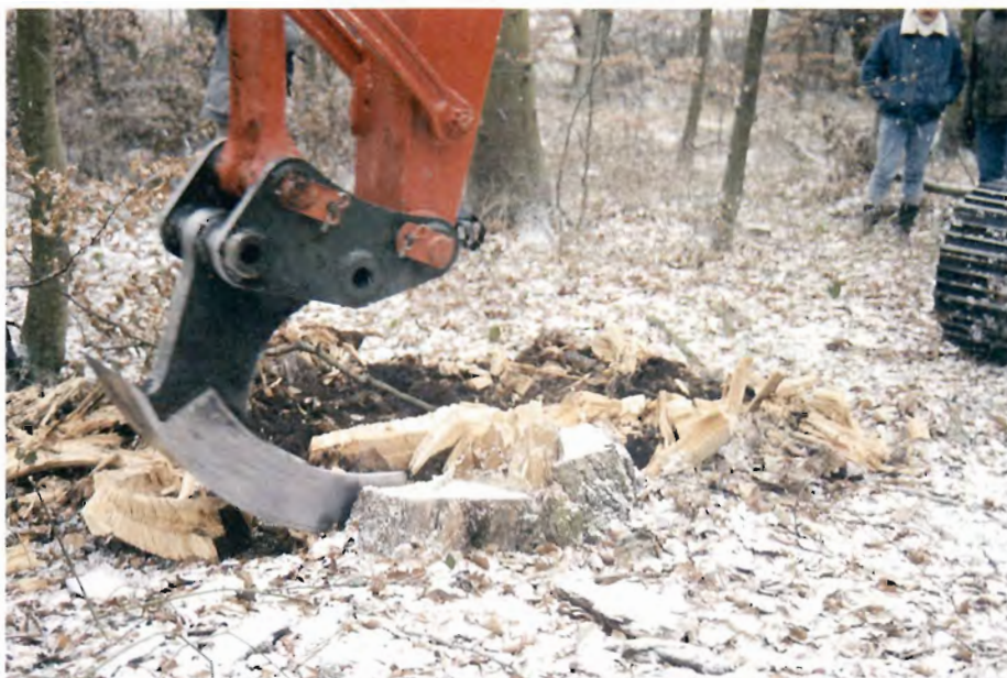
Figur 5. Becker stødrydder "graver" sig gennem stødet og efterlader en pæn bunke sankebrænde.
