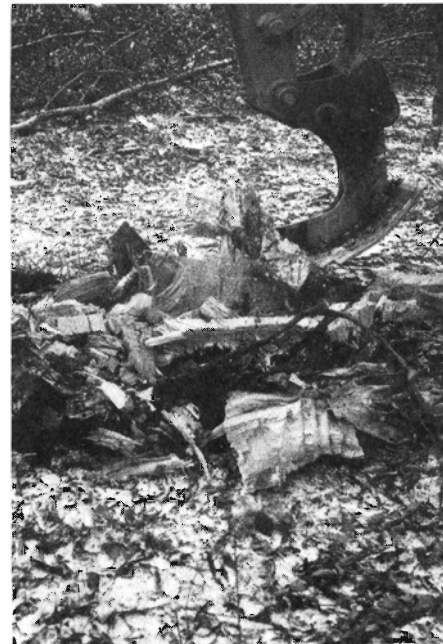
Figur 2. Dette stød blev skåret ned på ca. 80 sekunder. Bemærk "striberne" i veddet, der viser de enkelte snit.
