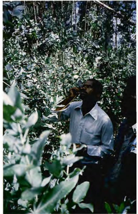
Figur 7. Træmålingsøvelser: Projektmanager Solomon øver sig i brug af hypsometer (Suunto).
