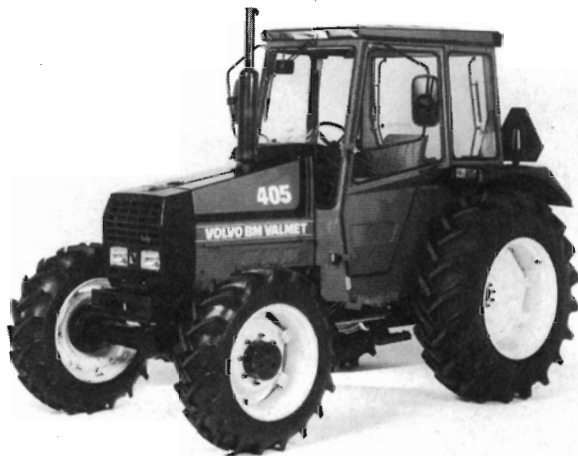
Figur 1. VOLVO-BM-VALMET 405-4 på 45 kW er en smidig traktor med god frihøjde og en stærk lift. Dette i forbindelse med gode indstigningsforhold gør traktoren egnet som udslæbningstraktor.
