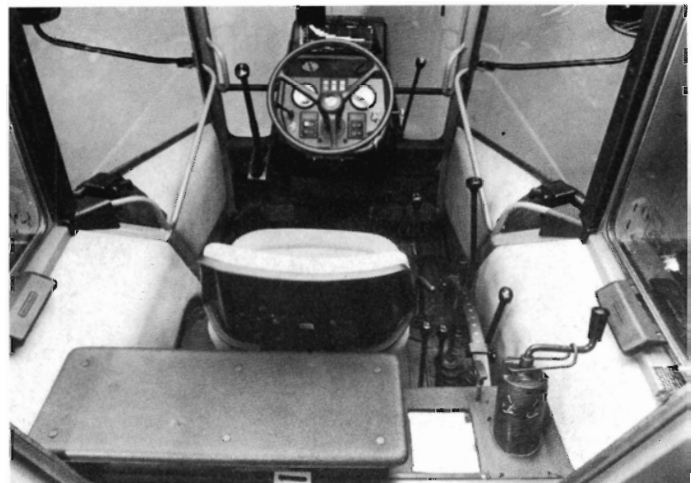
Figur 2. Førerkabinen er kendt fra Valmet traktorerne, men indretningen er langt bedre. Alle betjeningshåndtag sidder godt, og sædet kan drejes. Der er ikke mulighed for bagudvendt førerplads i denne traktorstørrelse.
