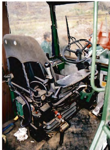
Førerkabinen er ombygget så rat og instrumentering vender fremad.
