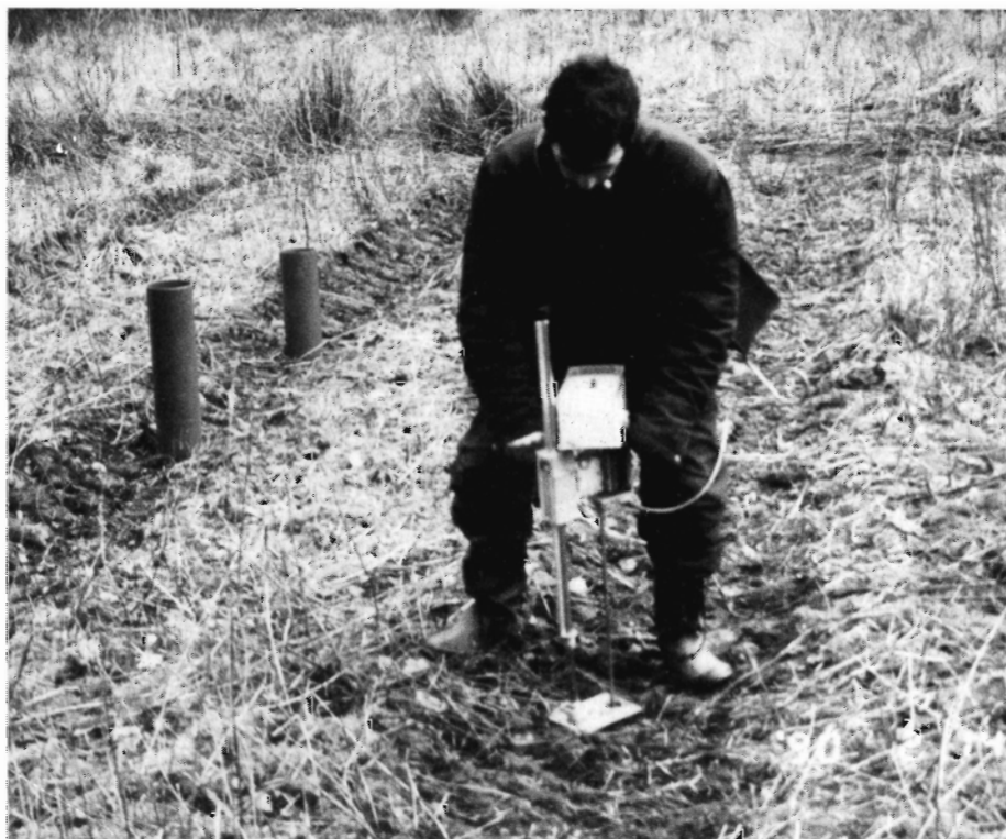
Figur 3. Måling af jordkomprimering med jordpenetrometer. I baggrunden jordinfiltrometre.
