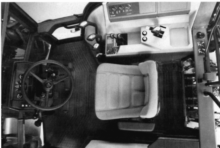
Figur 2. Der er god benplads bagud i førerkabinen, og det giver mulighed for en fuldt vendbar førerplads.
