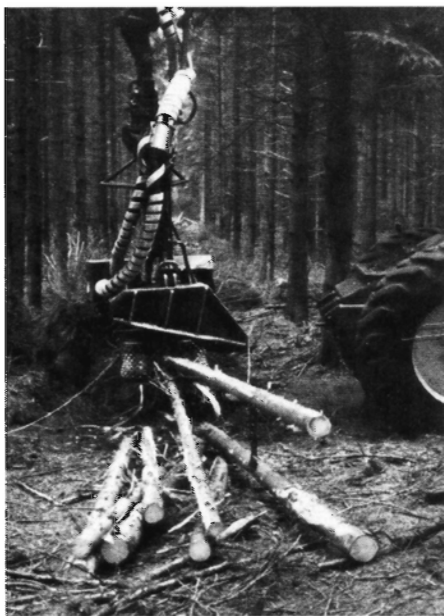
Figur 2. Flertræafkvistning af bunkelagte træer med Gremo SK35.
