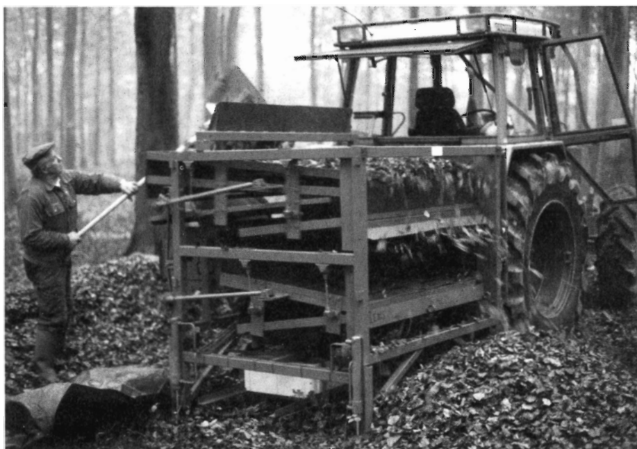
Det kan være nødvendigt at foretage en grovrensning i skoven for at fjerne især blade. Maskinen "Silvasat" arbejder med i alt 6 sold og kan rense op til renhedsprocent på 95.
