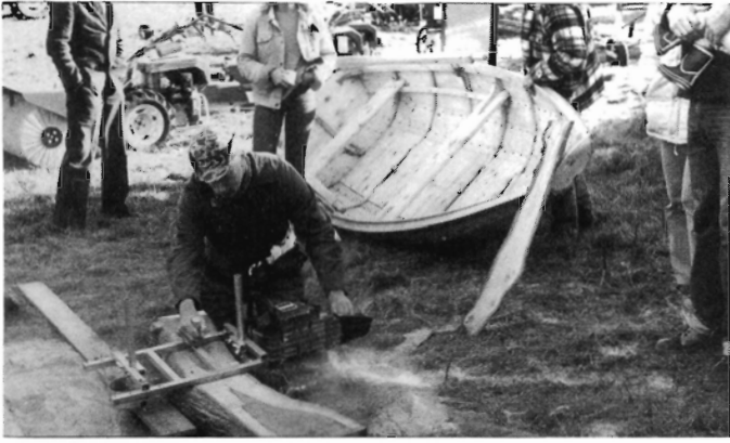
Tv.: Båden i baggrunden er bygget ved hjælp af egeplanker, der er skåret ud med motorsav påmonteret en plankeskærer. Th.: Sværdvending - saven udleveres med slap kæde, og skal afleveres med sværdet vendt og kæden strammet.
