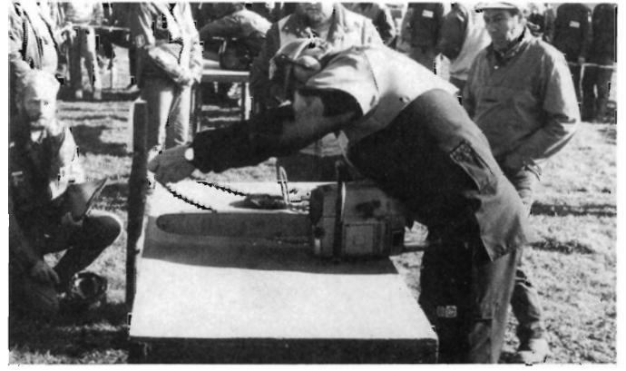
Tv.: Båden i baggrunden er bygget ved hjælp af egeplanker, der er skåret ud med motorsav påmonteret en plankeskærer. Th.: Sværdvending - saven udleveres med slap kæde, og skal afleveres med sværdet vendt og kæden strammet.
