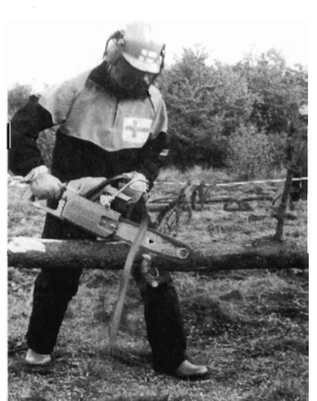
Tv.: Børnene kunne også bage snobrød. Midtfor: Under- og overskæring - der saves en skive af stammen med to snit nedfra og oppefra. Th.: Afkvistning.
