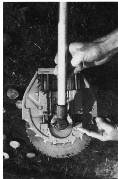
Figur 4. Unitech sikkerhedsskærm modvirker kast. Skærmens tænder fikserer buskrydderen på træet, hvorefter savklingen skubbes frem.
