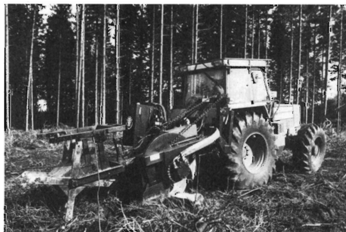
Figur 5. Kvasskæreren fjerner kvas og ukrudt forud for plantning (Rowitek i samarbejde med Skov- og Naturstyrelsen, prototype).
