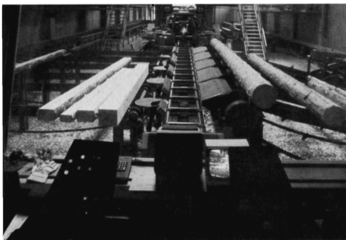
Figur 1. En af de senere investeringer er "Linje 2000", som er et moderne reducerbåndsavanlæg.
