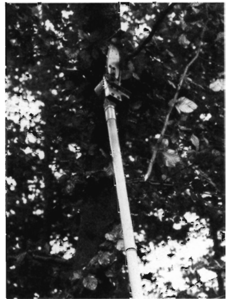
Figur 14. Opkvistningssav til produktion af knastfrit træ. (Husqvarna).
