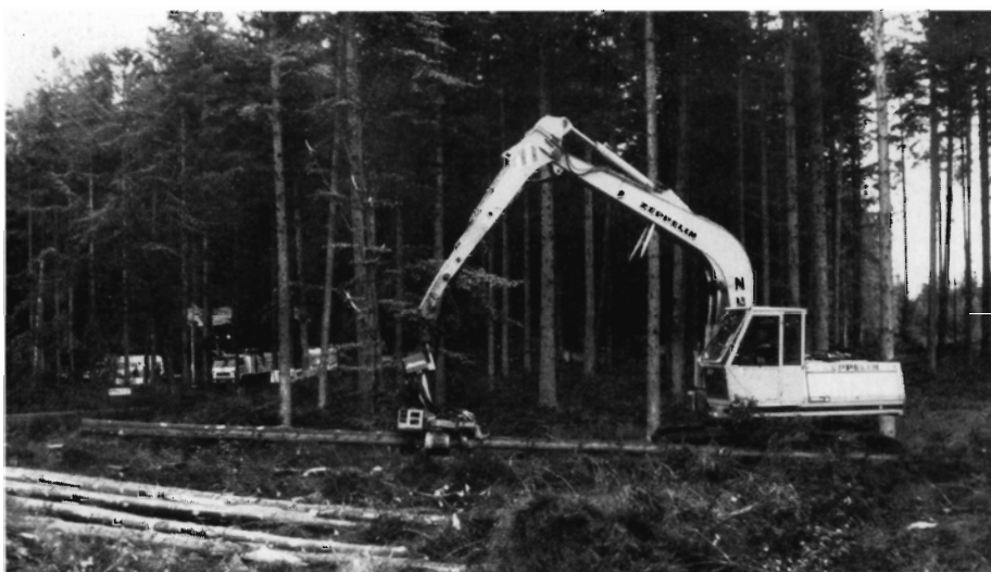
Figur 1. Skovning af stor rødgran med en gravemaskine forsynet med et processoraggregat (Silvatec).
