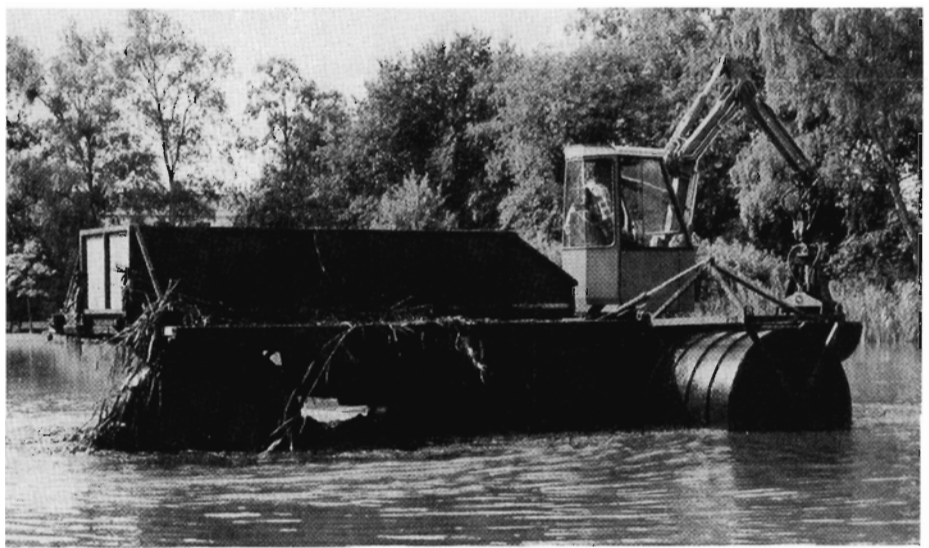
Figur 17. En amfibiegraver opbygget af en rørhøster, forsynet med pontoner og en let grave-maskine. (Bent Jensen).
