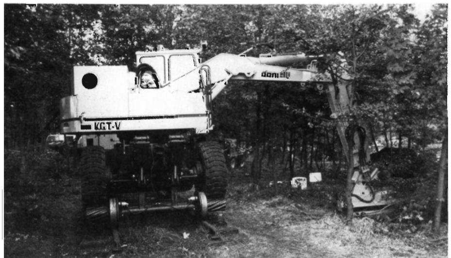
Figur 19. Maskine til beskæring af jernbaneskrånninger. (DSB).
