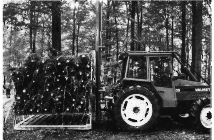
Figur 15. Juletræerne komprimeres med en særlig gaffel, og der slås bånd om (tv.) – hvorefter man har en færdig pakke som kan håndteres maskinelt (th.). (Erholmpallen).
