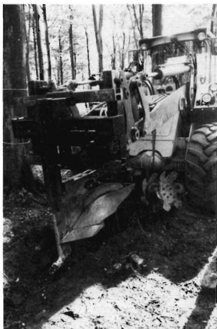
Figur 2. En kraftig grubber med plov og harve fjerner ukrudt forud for plantningen. (Jumbo GTI plov).
