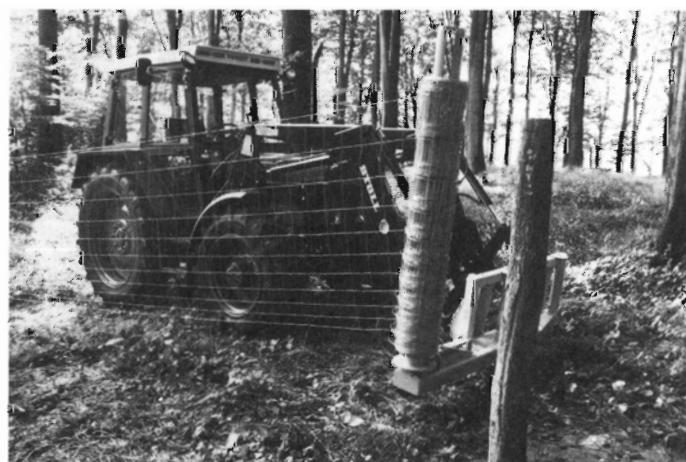
Figur 6. Opsætning af kulturhegn lettes når udrulningen sker i lodret position (VO-nemt hegnsopsætter).
