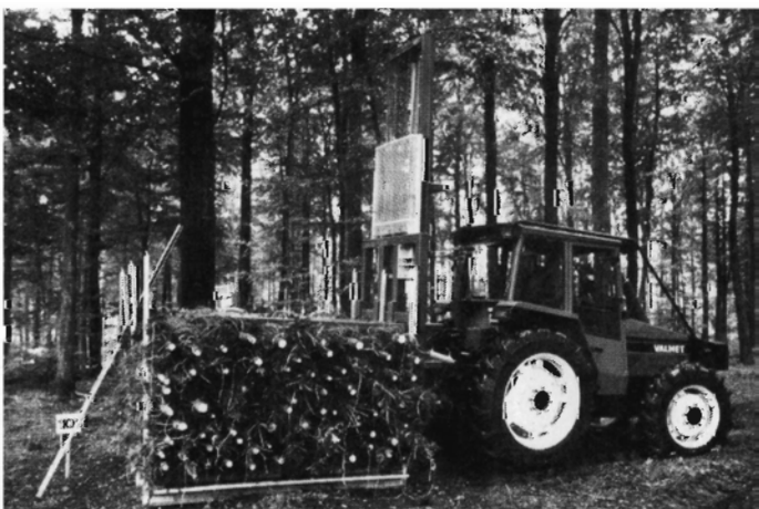
Figur 15. Juletræerne komprimeres med en særlig gaffel, og der slås bånd om (tv.) – hvorefter man har en færdig pakke som kan håndteres maskinelt (th.). (Erholmpallen).
