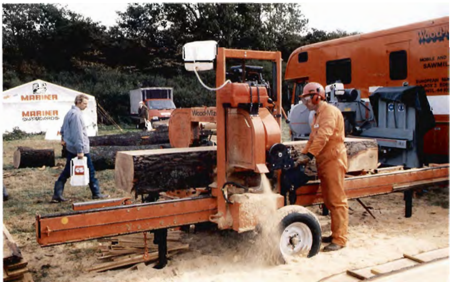
Figur 11. Mobil båndsav, som skærer en planke ud af en knapt 3 m lang egestamme på præcist 1 minut (Wood-Mizer).
