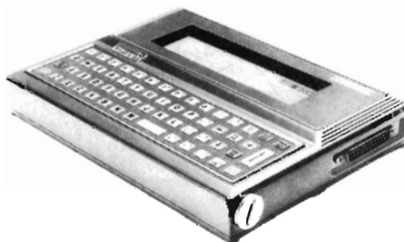
Figur 1. Husky Hunter er en lille bærbar og meget robust mikrocomputer med fuldt tastatur og skærm.
