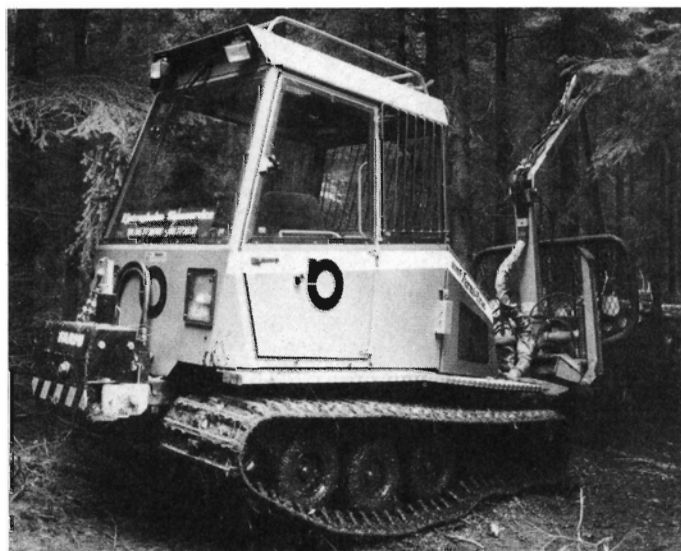
Figur 5. Bæltetraktorer kan være løsningen under vanskelige transportforhold (Farmi-Trac/Ejstrupholm).
