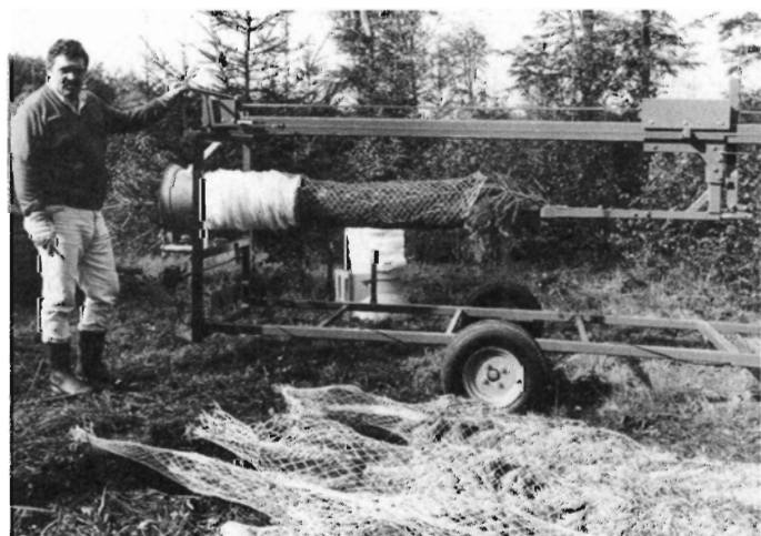
Figur 6. Med en automatisk netmaskine spares kræfter – og træet kan trykkes fastere sammen (Schneider/Hartving).
