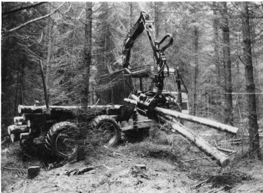
På Skovteknisk Instituts maskindemonstration på Langesø blev der bl.a. vist et stort udvalg af maskiner til skovning og transport (Silvatec F70 udkørselstraktor).
