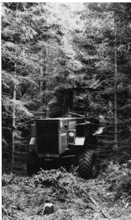
Figur 1. For at undgå skader på bevoksningen bør man satse på smalle skovnings- og transportmaskiner. Her Kockum 81-11 som er 1.87 m i bredden.
