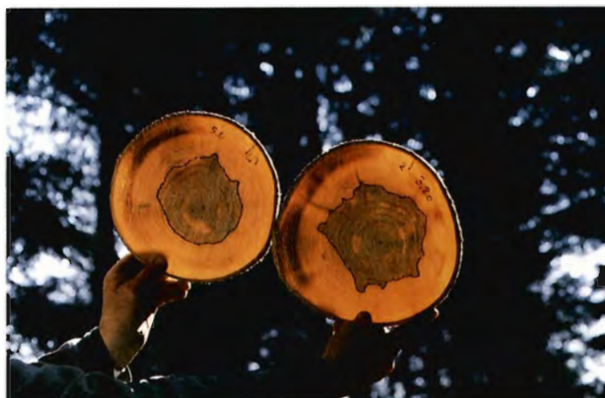
Foto 2. Grænsen imellem hjerte- og splintved ses let på stammeskiver, der holdes imod lyset. Her er grænserne blevet markeret med en sprit-pen.
