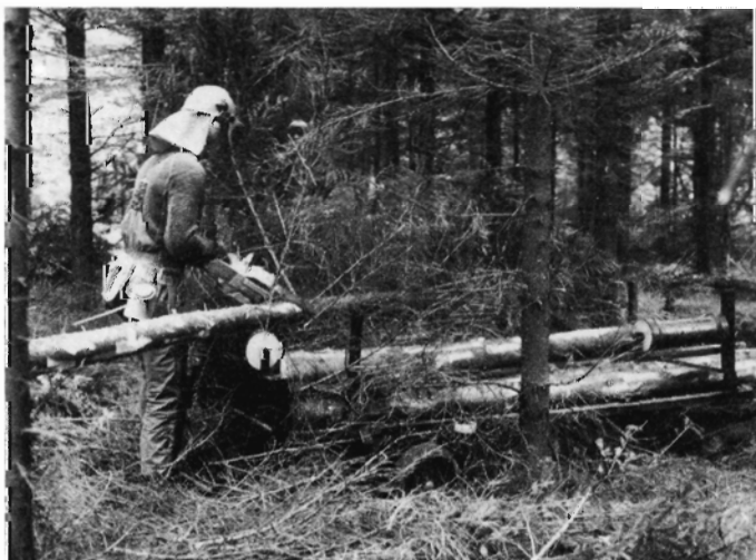
Figur 2. En hjælp for skovarbejderen til at klare transport til spor er den lille bæltetraktor "Jernhesten". Her er der efterhængt en bogievogn med arbejdsruller. De giver en bekvem arbejds-højde ved afkvistningen, og man undgår løft af 3 m-stykkerne.
