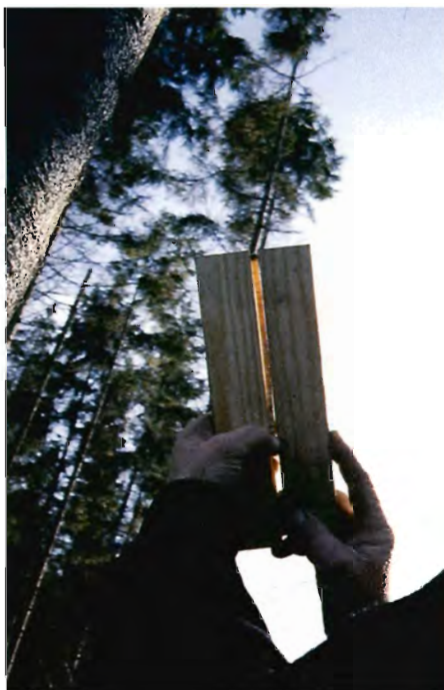
Foto 1. Grænsen mellem hjerte- og splintved bestemmes ved gennemlysning.
