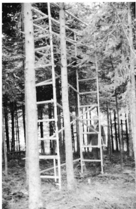
Figur 3. Vectur byggestillads er så smalt, at det kan flyttes mellem træækkerne.
