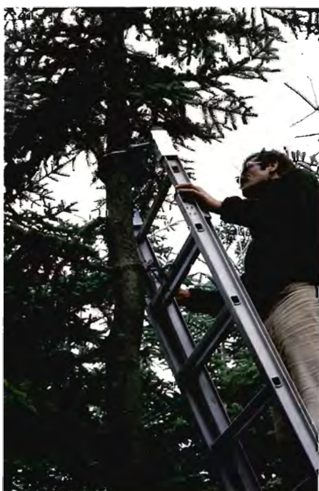
Figur 1. Stigeklo, der kan påmonteres alle letmetalstiger.
