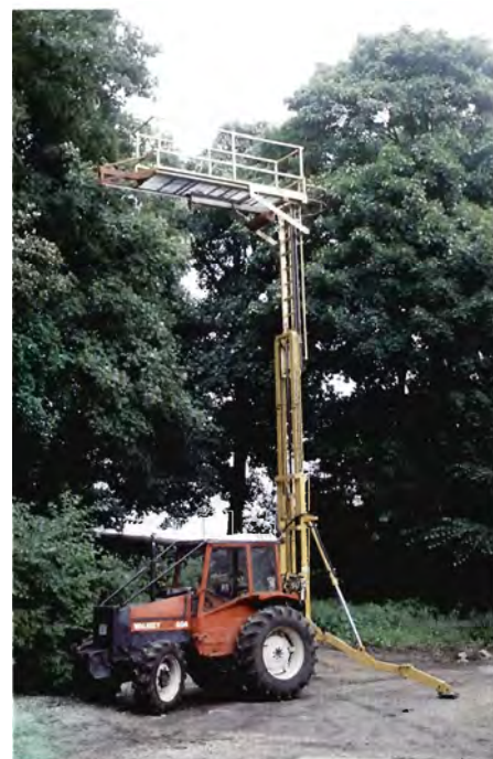
Figur 5. JES arbejdsplatform, der arbejder i det lodrette plan.
