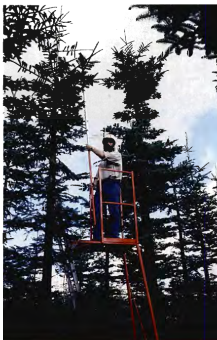
Figur 2. Prototype af stigeplatform, der giver en sikker ståplads under klippingen.
