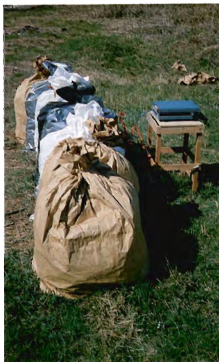
Fig. 5. Lagring af planter på friland i 3-lags papirsække og dobbelte plaatsække med hvid, sort og sølvfarvet ydersæk. Forreste og bageste papirsæk er attrapper. Th. udstyr til måling af temperaturer i sækkene. Foto: JN 19/4 - 84.
