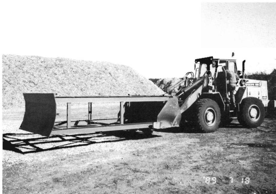
Figur 1. Flisskubber, der er konstrueret af Holstebro kommune. Skubberen bruges til høj stakning flis uden kørsel i stakken.
