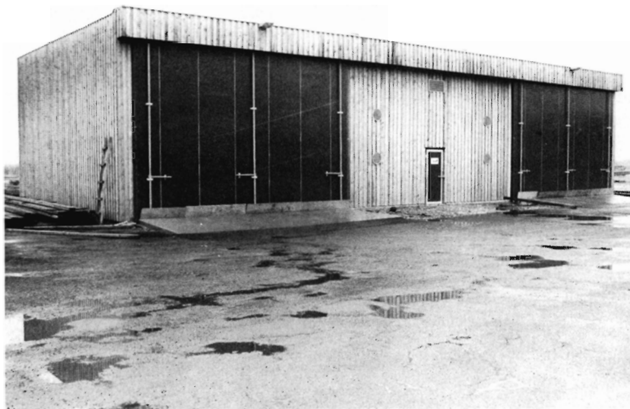
Figur 2. I nåletræindustrien vil man se en stigende grad af forædling, f.eks. tørring (billedet viser tørrestuer), høvling, profilering og limning.
