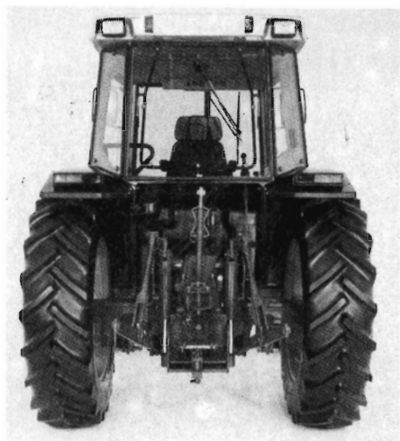
Figur 2. MF 3000 set bagfra er karakteristisk med sine skrå bagruder. Liften har to udvendige løftecylindre, der tillige kan suppleres med hiichkrog.
