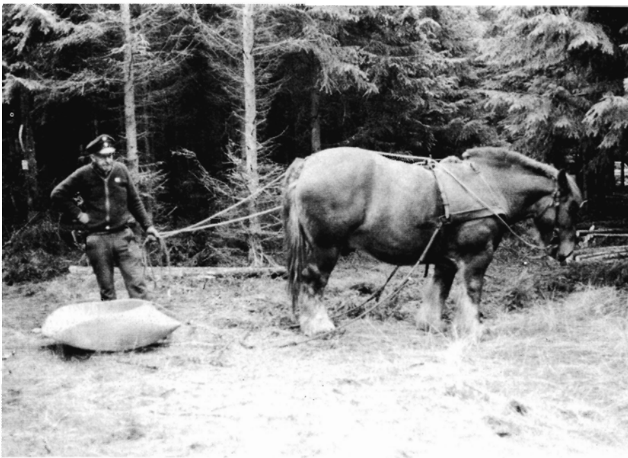
Fig. 5. Komplet udstyr til udslæbning af småtømmer og rummetereffekter med slæde. Videre-transport med traktor. Præstation: 3.2 m 3 /time, pris 100 kr./time alt incl.
