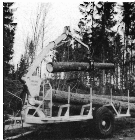
Fig. 6. P.V. skovvogn. Vognen er forsynet med hydrostatisk drev på forreste hjul i hver bogie.
