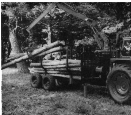
Fig. 7. Häglingsvognen III. 8 t kærre med mekanisk drev på vognen.
