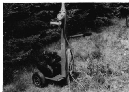
Fig. 2. Dynamotor 12 V-generator. Her med en Little Wonder hækkeklipper i olieskeden.
