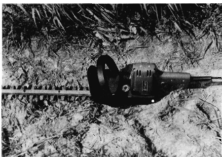
Fig. 3. Metabo 8014 S automatic. Man bemærker beskyttelsespladen foran håndbøjlen.
