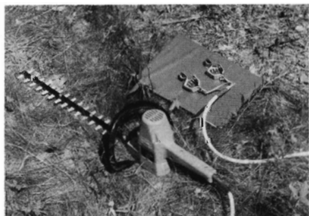
Fig. 6. Freunde 400 DG 12 V. Klipperen er forsynet med et langt kabel med to kraftige klemmer.
