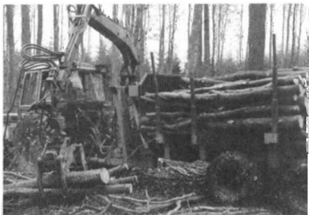
Fig. 5. Molgjer 8 t skovvogn monteret med Scan Chief kran. Vognen fås også som 5 t enakslet kærre.
