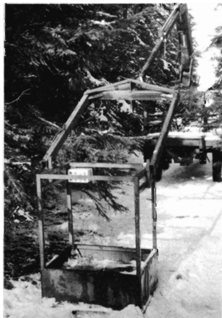
Fig. 2. Arbejdsplatformen. Der bemærkes den hvide boks med elektriske trykknapper til betjening af alle kranens funktioner.
