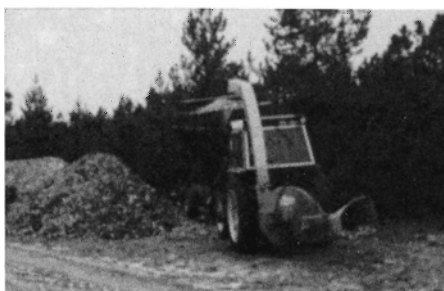
Fig. 5. Flishugger og højtippvogn monteret i hver sin ende af traktoren. Scanhugger S-10.
