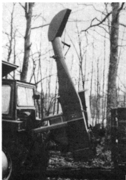
Fig. 4. Tromlehugger monteret mellem traktor og vogn, indmadningstragten slået op i transportstilling. Erjo 160 T.
