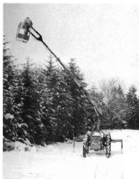
Fig. 1. Man får et indtryk af kranplatformens store rækkevidde. Foran på traktoren anes den gaffel, kranen lægges i under transport.
