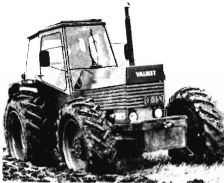
Fig. 1. Den firehjulstrukne Valmet 702 S
