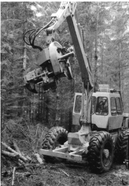
Fig. 14. Strenab 35 kranprocessor med et pigbælte til fremmadning og rundsav til afkortning.
