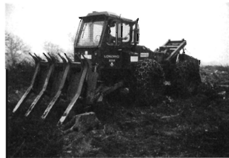
Fig. 17. Kvasrydningsaggregatet Räumfix er et dozerblad med bevægelige tænder.
