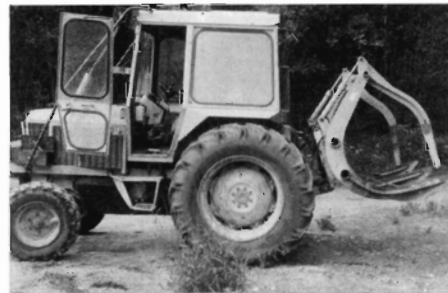
BSH-kvasgreb monteret i lynkoblingsramme på Rollo-skovtrac.
