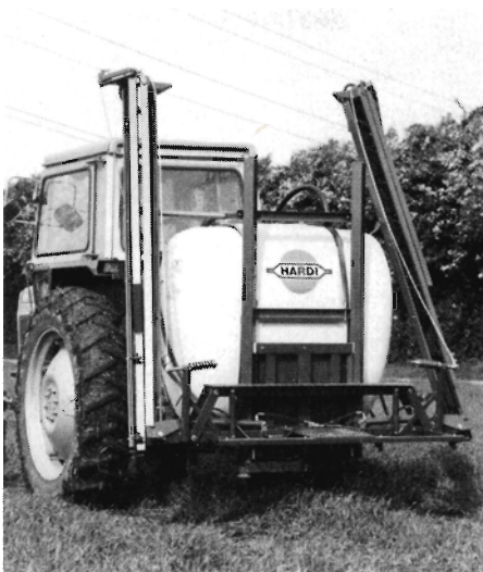
Fig. 16. Fuldhydraulisk 12 m spredebom fra Hardi.
