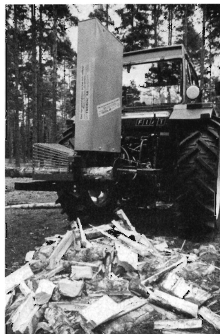
Fig. 4. Hydraulisk brændemaskine der kapper og kløver i én arbejdsgang.
