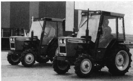
Fig. 15. Ford 1700 og 1900 er på 18 og 22 kW og har 4-hjulsdriv som standard.
