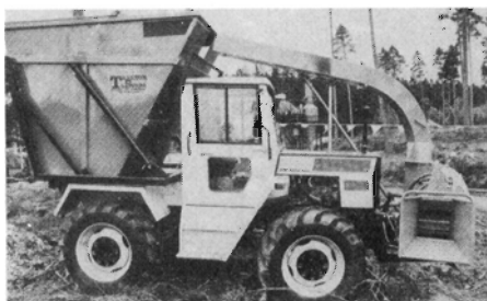
Fig. 3. MB-trac med frontmonteret POMA flishugger og chassismonteret fliscontainer med højtipp.
