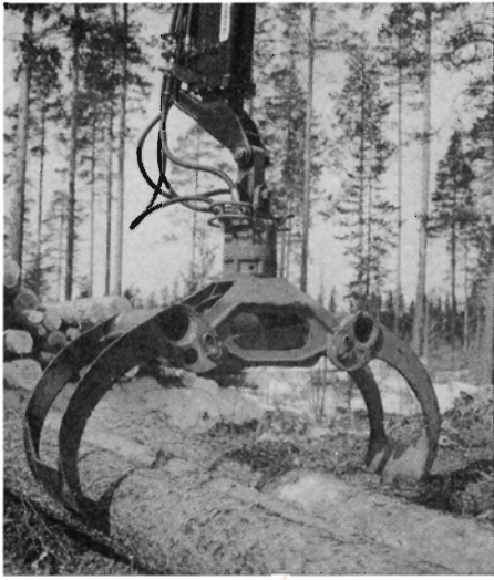
Fig. 6. Cranab-grab LB-0,35 med sammenbygget rotator.
