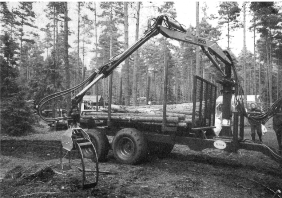
Fig. 8. KMA-skovvogn med IIsbo 2100 kran med hydraulisk stempel alene som udskyder.
