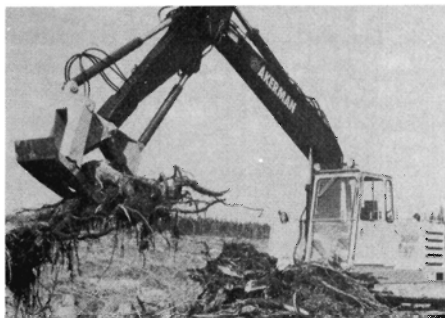
Fig. 2. Herkules stødoptager til montering på gravemaskine.
