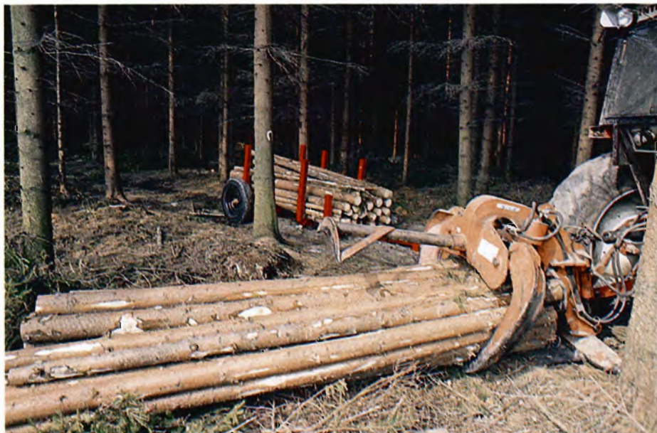
Fig. 5. Kombitang med tangkærre under udkørsel af 3-m gran.
