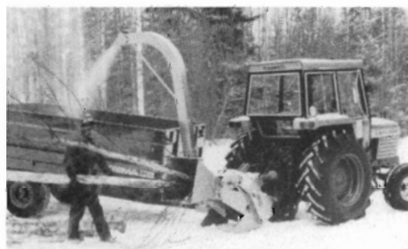
Fig. 25: Bruks 722. Vægt 650 kg, max. rundtrædiameter 20 cm, effektbehov større end 30 kW.
