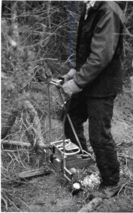
Fig. 4: Husqvarna fældebojle for opretstående fældning med motorsav. (SI-foto).
