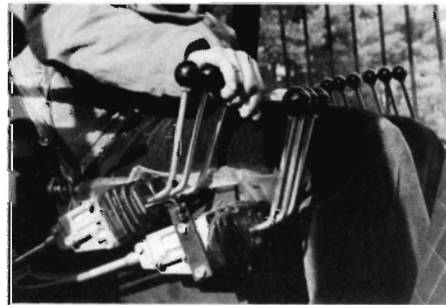
Fig. 18: Mekaniseret kabelbetjening af traktors hydraulik. (SI-foto).
