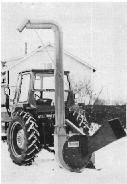
Fig. 23: Farmi. Vægt 450 kg, max. rundtrædiameter 20 cm, effektbehov 30-65 kW.
