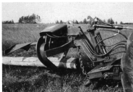
Fig. 2: Loft-kombitang til udsælbnings og til udkørsel af afkortet træ. Tangen er en prototype, som kan svinges til siderne. (SI-foto).
