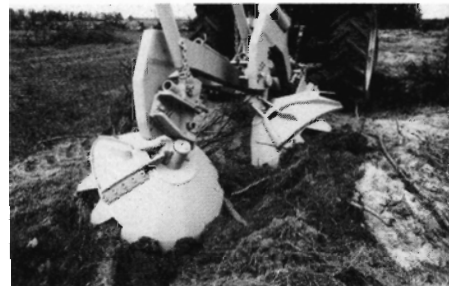
Fig.9: LOFT-ploven har fået ændret tallerkenophængenes vinkel og er blevet udstyret med hydraulisk manøvreret forskær.
