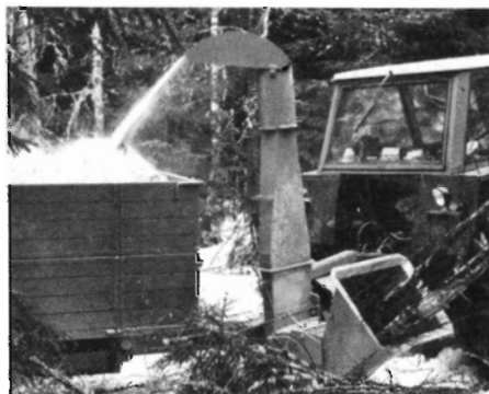
Fig. 22: Erjo. Vægt 550 kg, max. rundtrædiameter 22 cm, effektbehov større end 26 kW.
