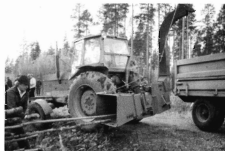
Fig. 24: Junkkari SL 6. Vægt 440 kg, max. rundtrædiameter 15 cm, effektbehov 22-55 kW. (SI-foto).
