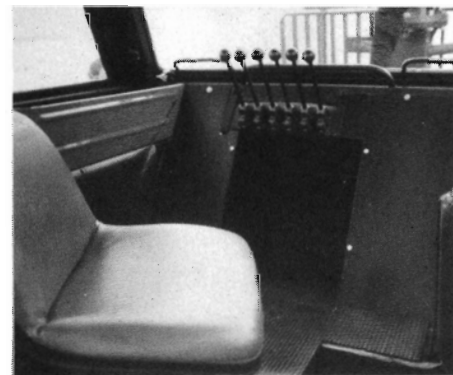
Fig. 14: Kranbetjeningsplads i URSUS-skov- traktor. (SI-foto).
