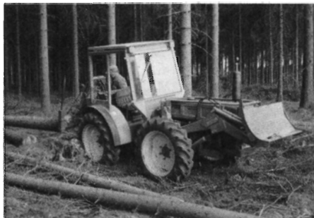
Fig. 1: Holder A60 er en lille midjestyret traktor, velegnet til udsælbnings i mellemaldrende granbevoksninger. (SI-foto).
