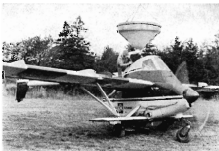
Fig. 4. Efter landingen kan flyvemaskiner hurtigt læsses med gødning fra »tragten«. Beholderen, der løftes af en kran, fyldes, så den er klar til næste læsning, medens flyet er i luften (KFK).
