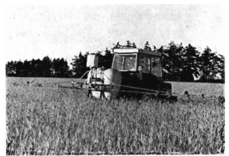
5. Loft elevatorsprøjte med ULV-spredere.
